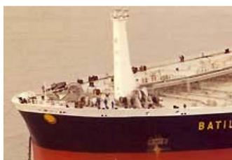
On remarque à l'arrière un curieux dispositif pour ramener plus bas le point de traction des remorques.
